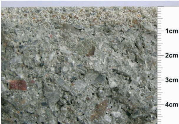
Weissenböck Pflasterstein durchgespalten mit mind. 5 mm Vorsatzbetonschicht und Kernbeton.
