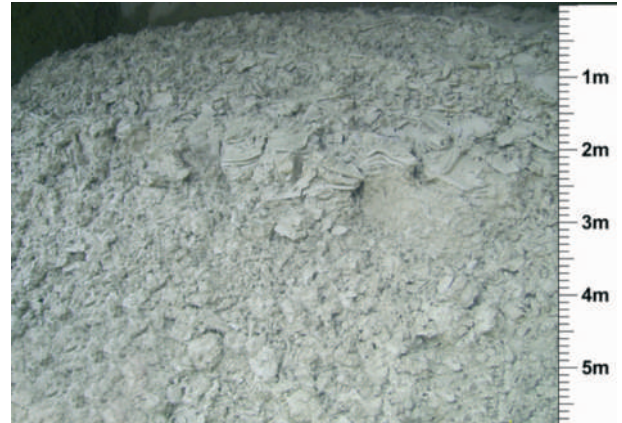
Bis zu 20 Masse% des Sandkorngewichtes am Umhüllungslehm werden aus den harten Vorsatz-Quarzsanden herausgewaschen und -gerieben.
